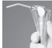
8. Tirer d'un coup sec sur l'extrémité ouverte du manchon pour former un joint étanche autour de l'embout au niveau de l'écrou d'extrémité. Pour de meilleurs résultats, pousser le manchon pour le faire glisser le long de l'embout,
